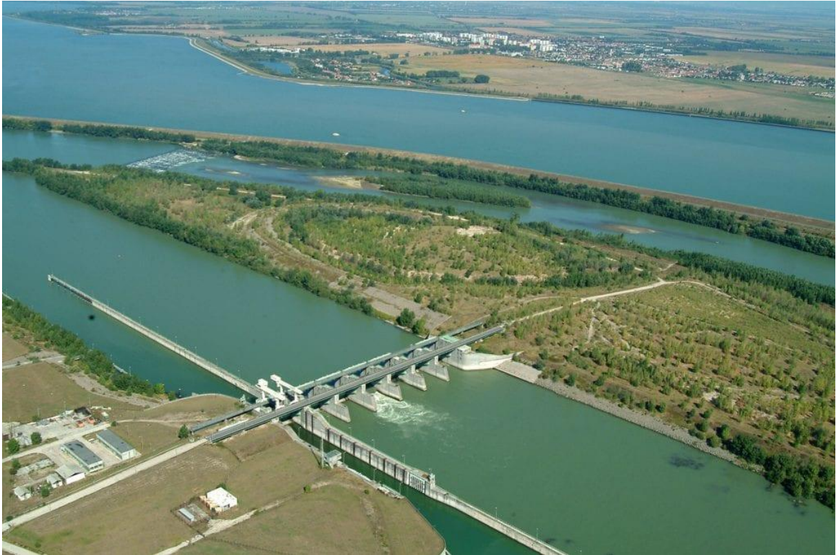
28. kép: Dunakiliti duzzasztómű lent, középen a Nagy-Dunán a fenékküszöb, legfelül a Bósi erőműig érő szlovákiai felvív csatorna. https://www.dunakiliti.hu/dunakiliti-duzzasztomu/
